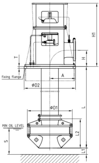
DISCHARGE FLANGE DN 200;PN 16; DIN2501
